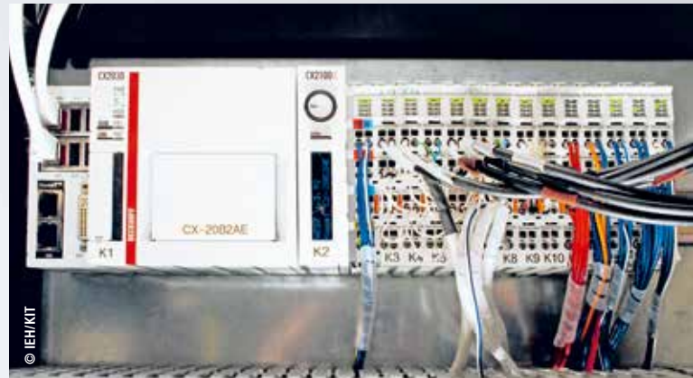
对于逆变器仿真，CX2030 嵌入式控制器可以实现 50 \mu\text{s} 的短控制周期
