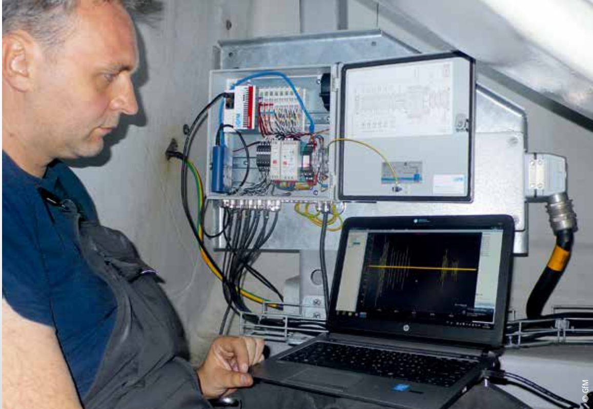
GfM 工程师正在进行与 Peakalyzer 连接的加速度 传感器测试
