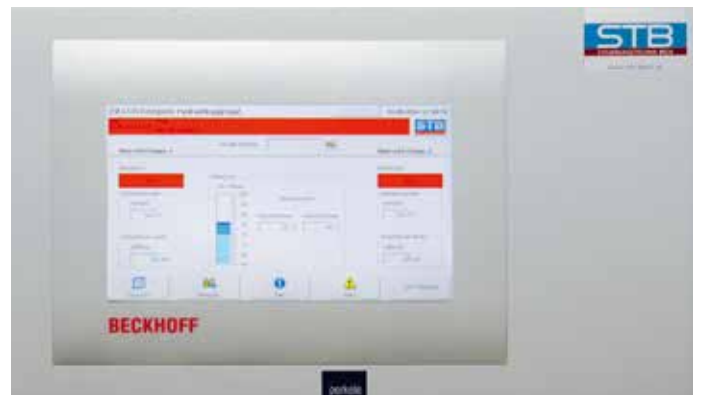
复杂的舞台机械通过一台面板型 PC 控制
