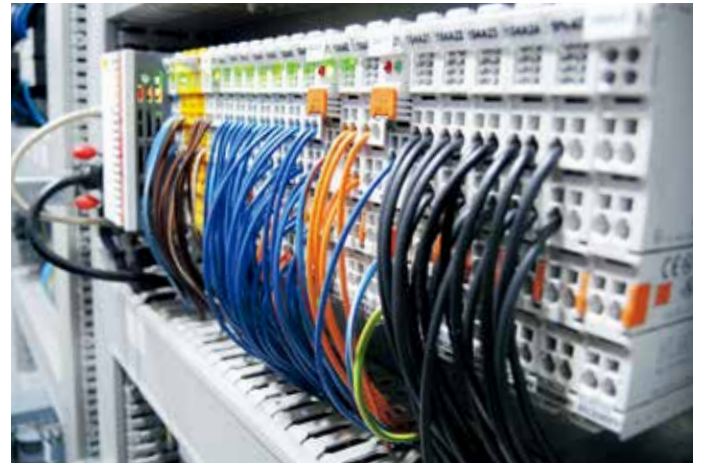
倍福的端子模块系统具有模块化设计特点，能够随时更换和添加，并且成本很低
