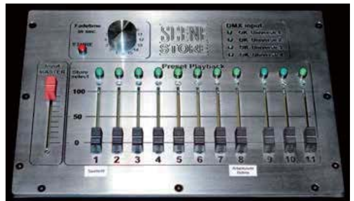
Scenestore 是由 Stage Entertainment 公司开发的第二套照明控制系统。系统独立于主照明控制台，用于彩排以及发生故障时用作应急照明
