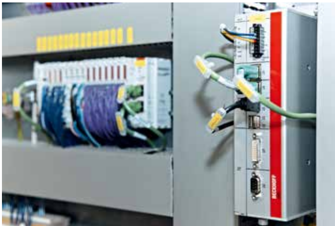
紧凑型控制柜式IPC C6920 采用双核处理器，能够同时控制加热区和壁厚
