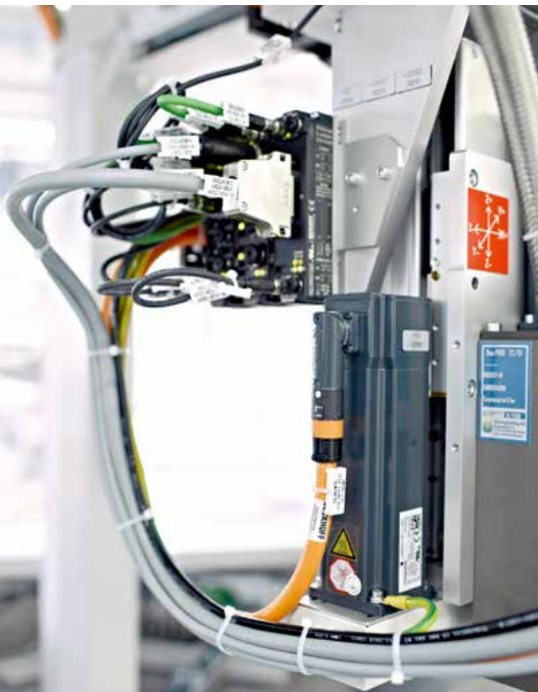
采用单电缆技术的小型伺服电机和分布式 EtherCAT I/O 端子盒支持超紧凑型机器设计
