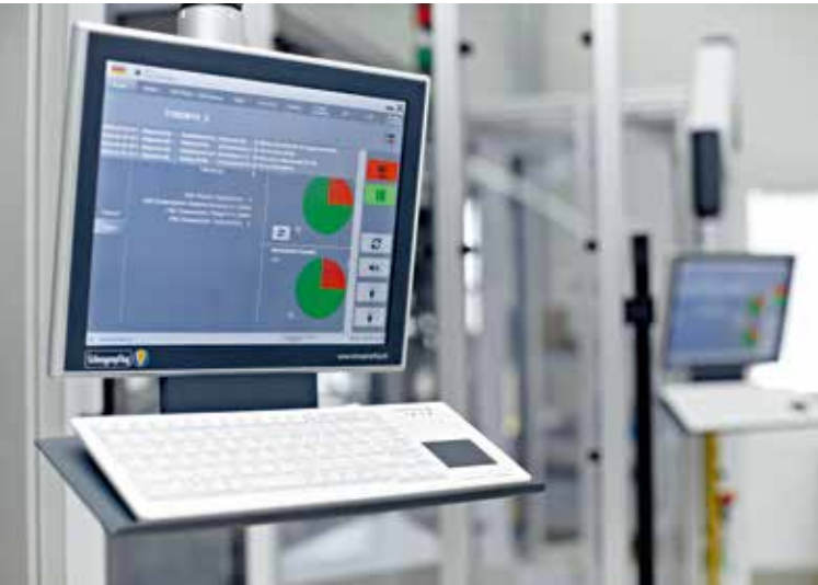
三台 CP3915 多点触控控制面板中的两台 一起确保可以从任何角度访问机器界面
