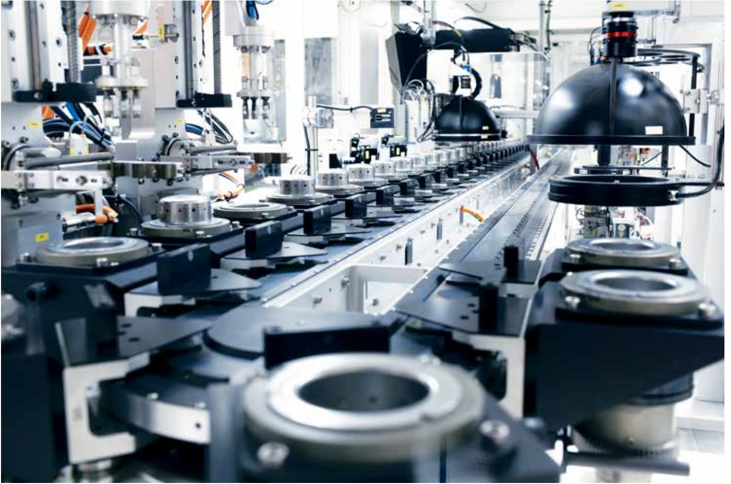
扩散器沿着“帽形”和“杯形”方向运动经过检测工位，其中有些型号完全相同
