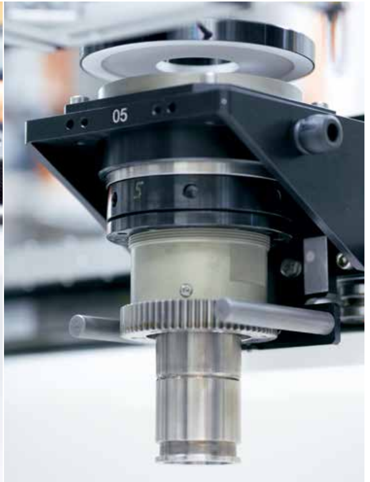
带有上下芯棒（左图和右图）的 XTS 动子沿着“帽形”或“杯形”方向拾取扩散器。还可以看到的是用于在线扫描相机前面旋转部件的链轮
