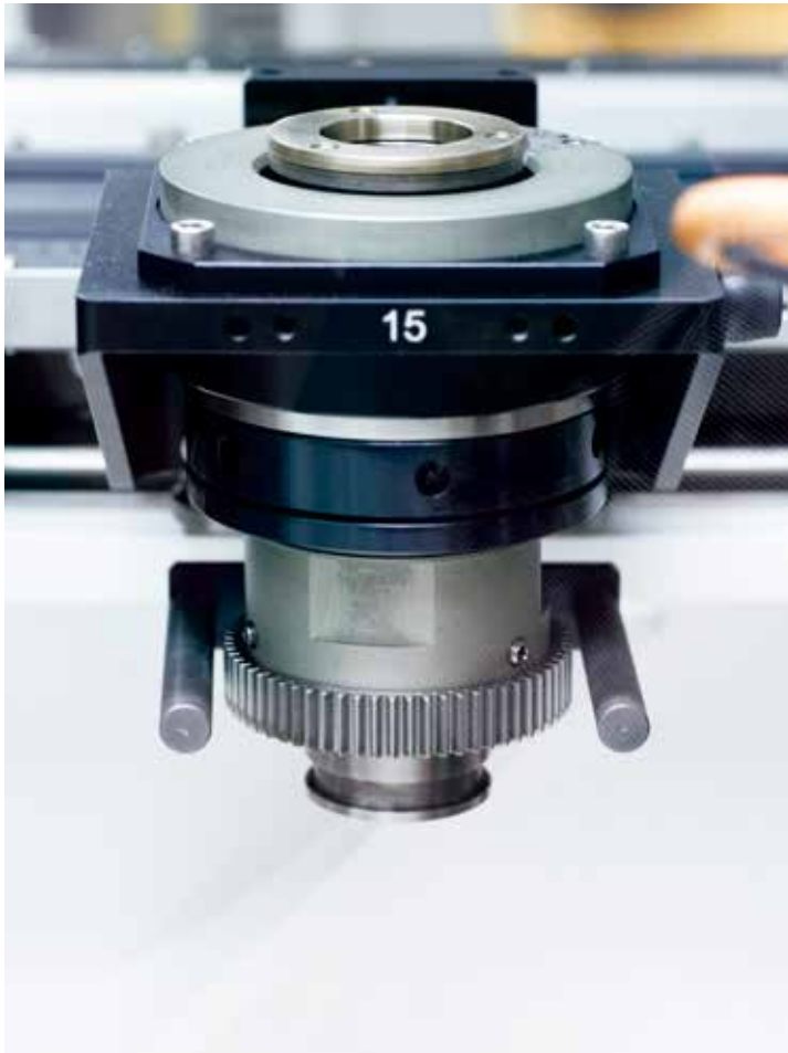
带有上下芯棒（左图和右图）的 XTS 动子沿着“帽形”或“杯形”方向拾取扩散器。还可以看到的是用于在线扫描相机前面旋转部件的链轮
