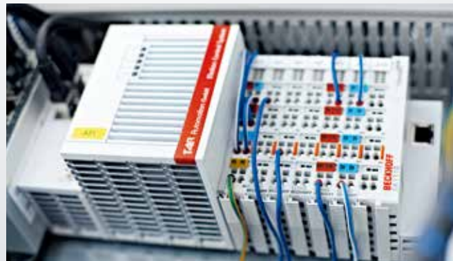
状态监测系统安装在一个紧凑的端子盒中，已经可以投入使用
