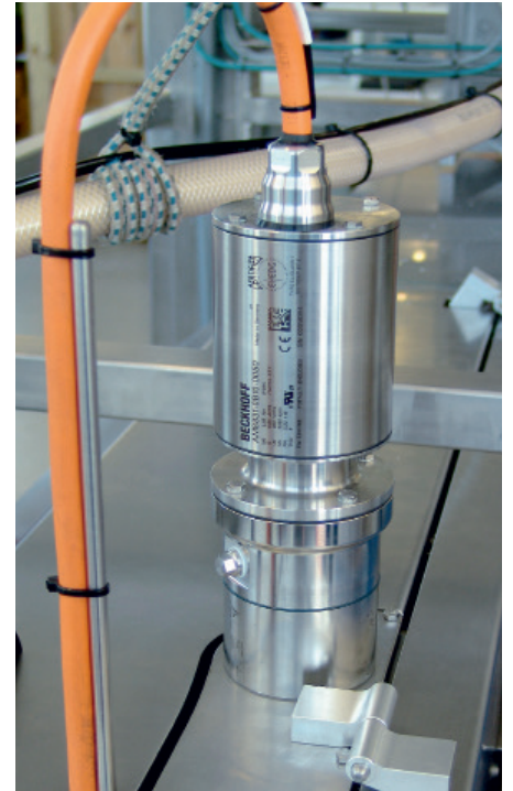
灌装工位的控制系统还集成了 AM8831 系列伺服电机，该系列采用了符合 EHEDG 认证的不锈钢外壳
