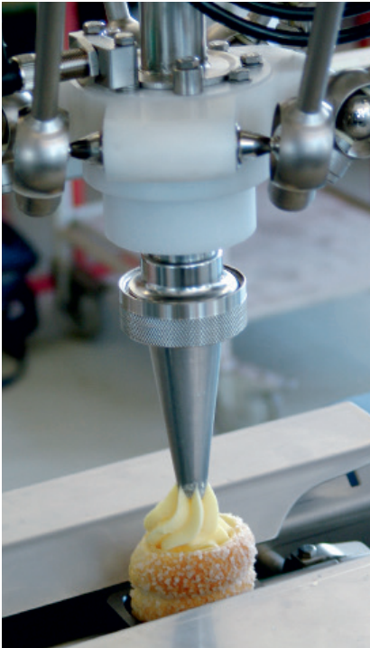
糕点盒笔直地送入到灌装中，以一个特定的高度和指定的距离放置
