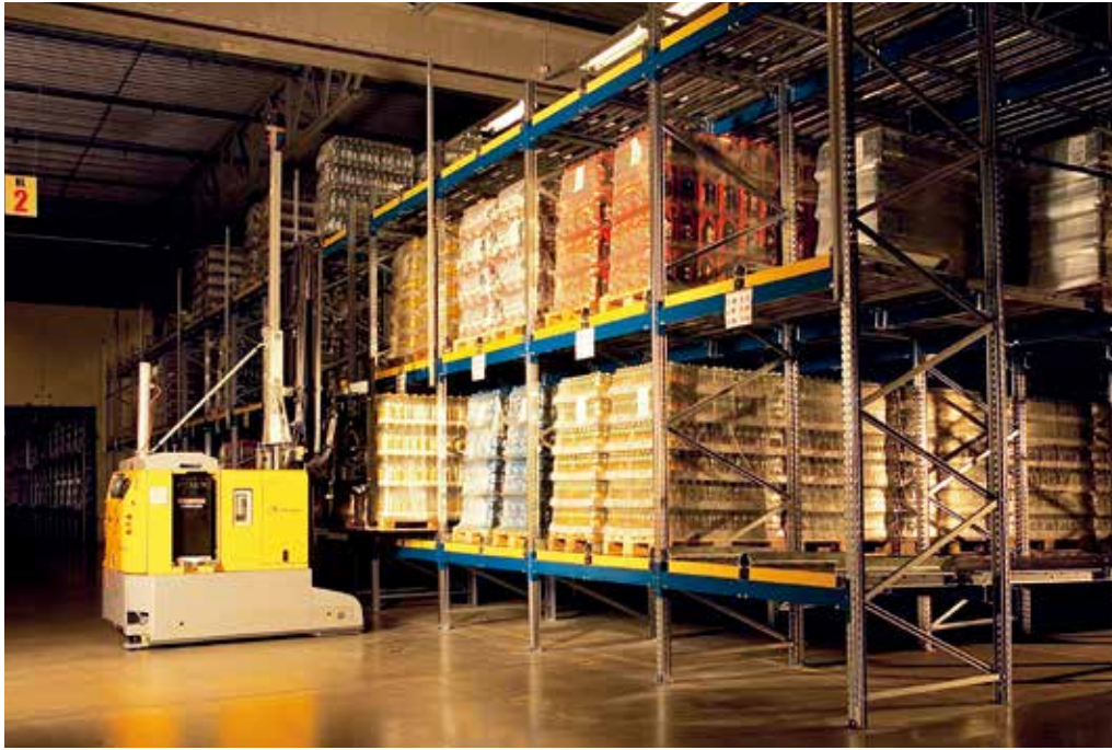
先进的物流系统基于自动引导车（AGV）能够有效地利用存储空间，从而降低成本
