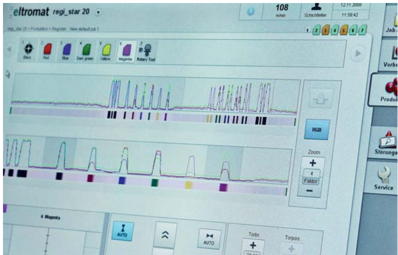
由于使用了 Beckhoff 的 XFC 技术，能够快速、精确地检测印标
