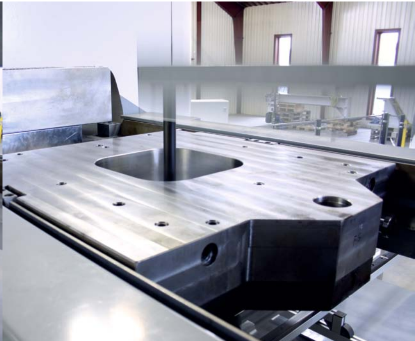
Kiermar 深拉压力机的主要特性：将成品推至输送带的同时水平移动上模。模具仅在实际压制时从底部移动至顶部。
