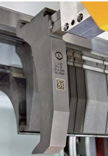
扫描仪识别刀具，并通过矩阵码的方式以极高的精度将刀具插入到滚板中
