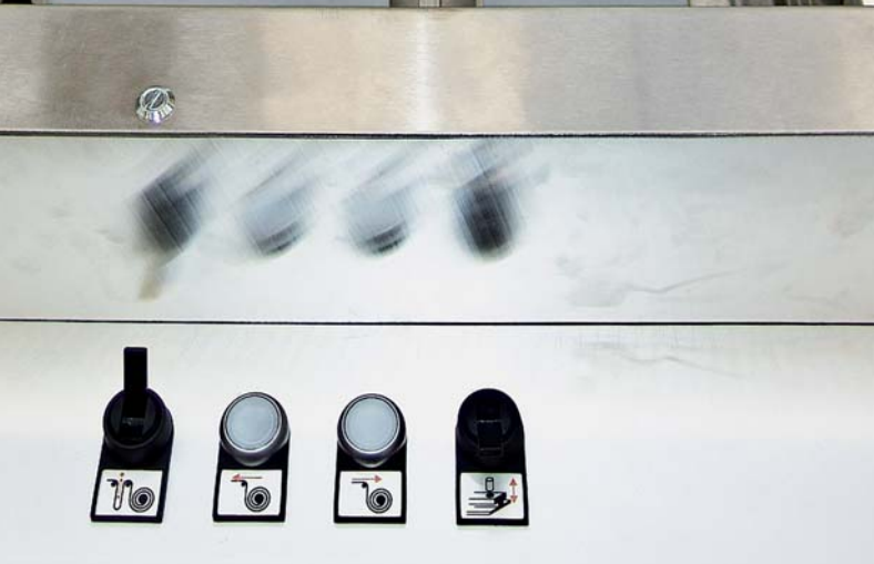
布幅托辊架的手动控制级，布卷可通过该控制级前进至机器内
