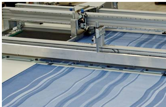
已切断的篷布幅通过牵引小车移动并放下；篷布通过切割台架张紧并进一步向前输送
