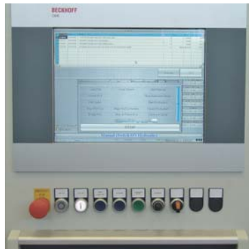
使用了 Beckhoff 面板型 PC C3640，装有 Windows XP Professional 操作系统和 Run-Time TwinCAT PLC
