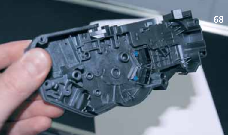
新生产出来的机电一体变速箱，包括已为通用汽车公司的汽车门锁系统安装的微动开关
