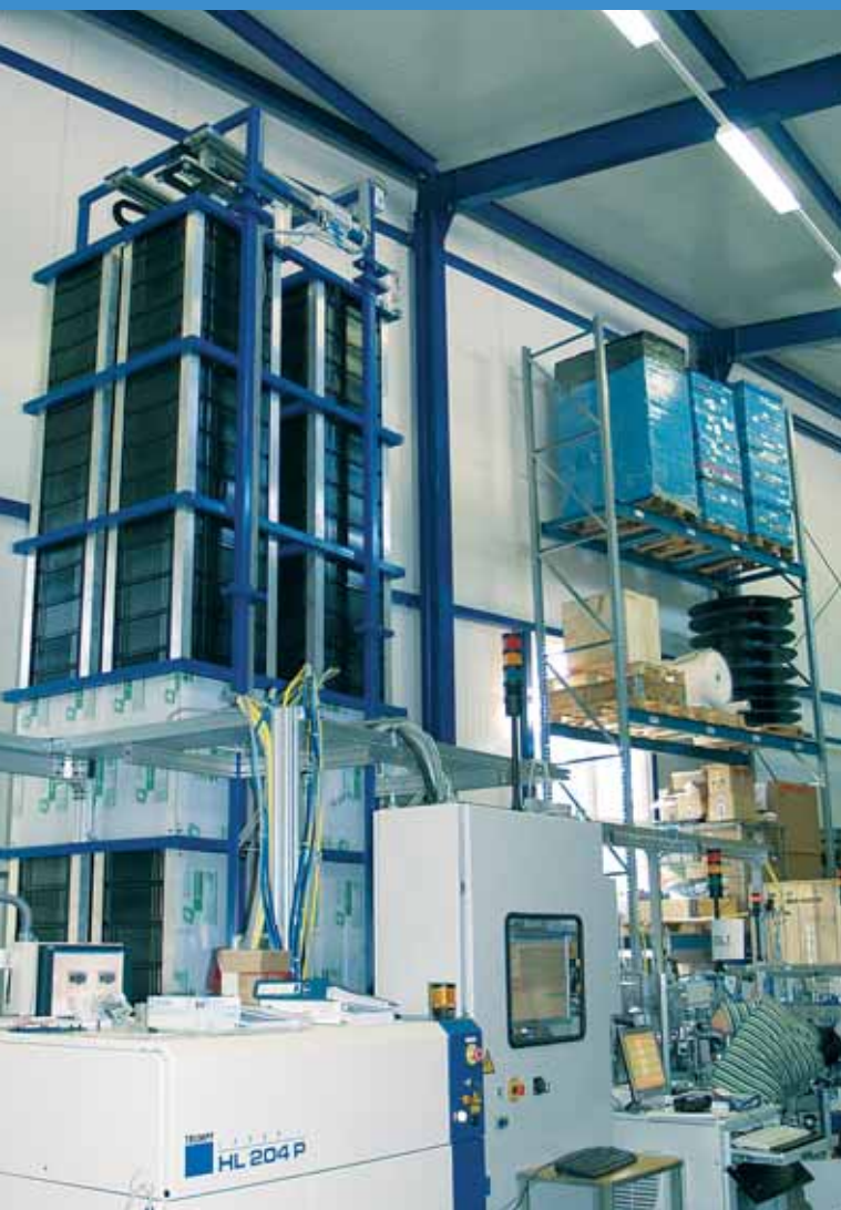
正在 Karlstein 工厂进行试验的最新珀尔曼生产设备：在最前面的是 Trumpf 激光焊接机；后面的是 4 米高的贮存塔，用于固化来自双组注塑工作站的浇铸件，同时也可被用作整个生产工艺内的缓冲仓库
