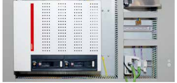
采用多核处理器技术的 C6650 控制柜式工业 PC 控制和监测 lisocore® 复合板的整个生产系统
