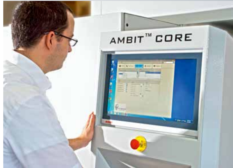
混合式系统通过一台倍福的 CP2218 多点触控面板型 PC 控制
