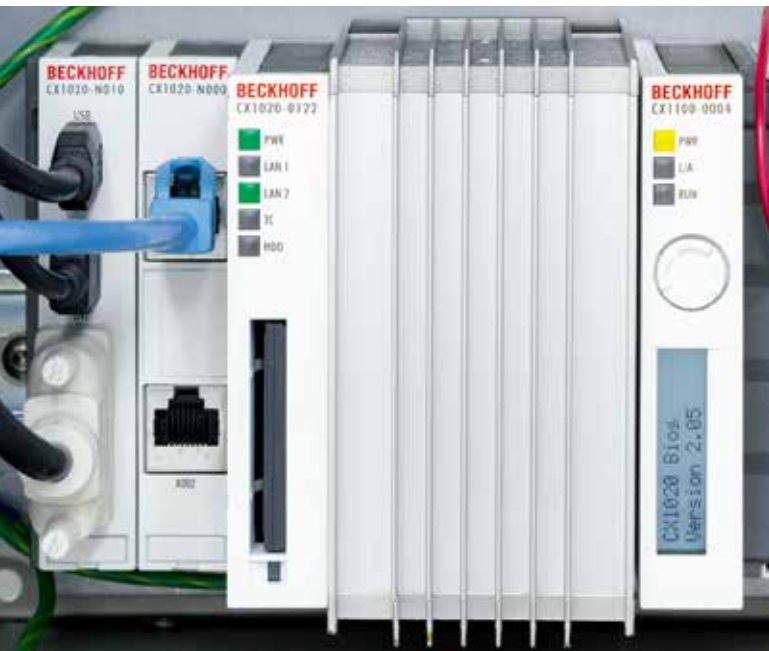
扭矩测试仪的核心组件是一台 CX1020 嵌入式控制器，它控制认证过程所需的所有测试功能
