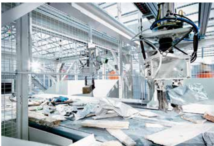
ZenRobotics 的回收系统使用自学习机器人高速度、高效率地将可回收材料从垃圾物流中分离出来
