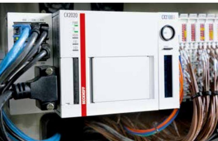
一台直接连接 I/O 端子模块且安装有 TwinCAT 3 自动化软件的 CX2020 嵌入式控制器用作 M1 合成器的中央处理器
