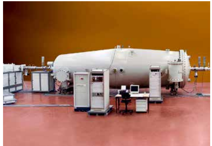
5 MV Tandatron 粒子加速器的金属罐，带绝缘气体与加速管
