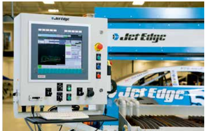
对于机器显示，Jet Edge 采用带 DVI/USB 扩展接口的 CP6912 控制面板，可以安装在距 C6920 工业 PC 50 米远处
