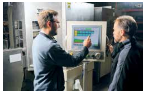
CP690x 系列“经济型”远程控制面板用于机床可视化
