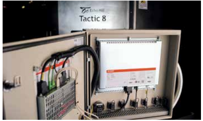
Echo Hill 通过一台 C6515 工业 PC 和 TwinCAT 自动化软件控制整个磨削单元，包括三个机器人和测量系统
