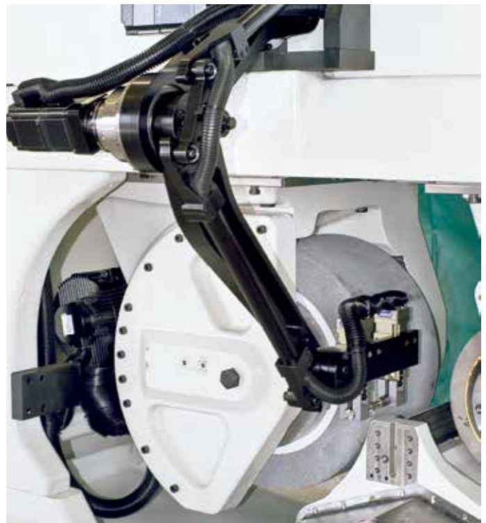
在无心磨削技术中，工件不是固定的，而是在一个快速旋转的磨轮和较慢旋转的小型调节轮之间旋转。例如，此项技术可以用于生产汽车、航空或航天行业使用的精密零件
