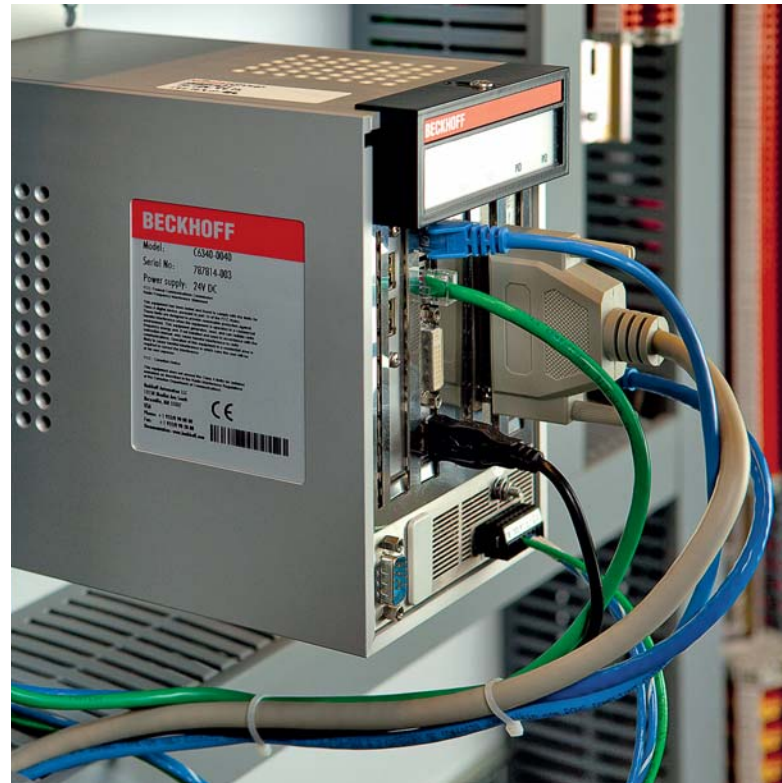
控制系统的核心部分是一台 Beckhoff 的工业 PC C6340，它采用的是 Intel® Pentium® M 1.8 GHz 处理器
