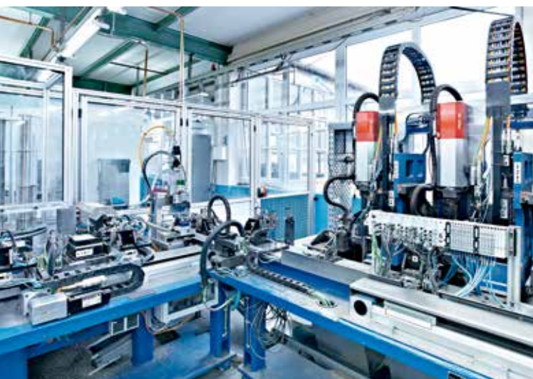
由 Aumat 和 AST 公司共同设计的互联钥匙生产线由一台钥匙切割机 and 一台仿形铣床构成，可以高精度地单件流加工钥匙坯
