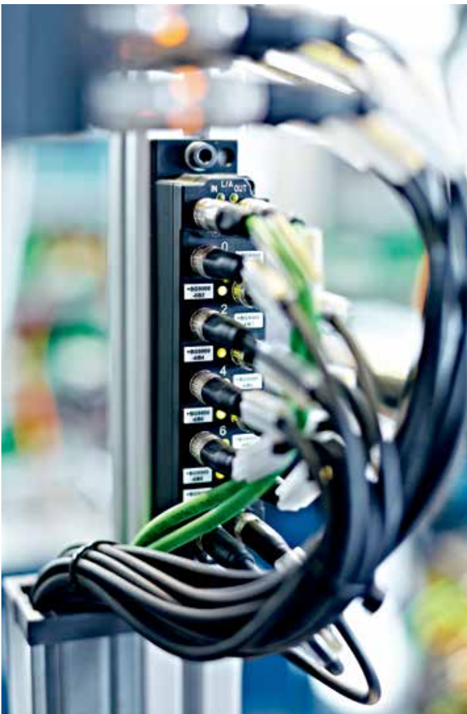
在加工过程中，通过 EtherCAT 端子盒、EP1008 和 EP2028 在现场直接分布式采集 I/O 数据可以大大减少所需的控制柜空间
