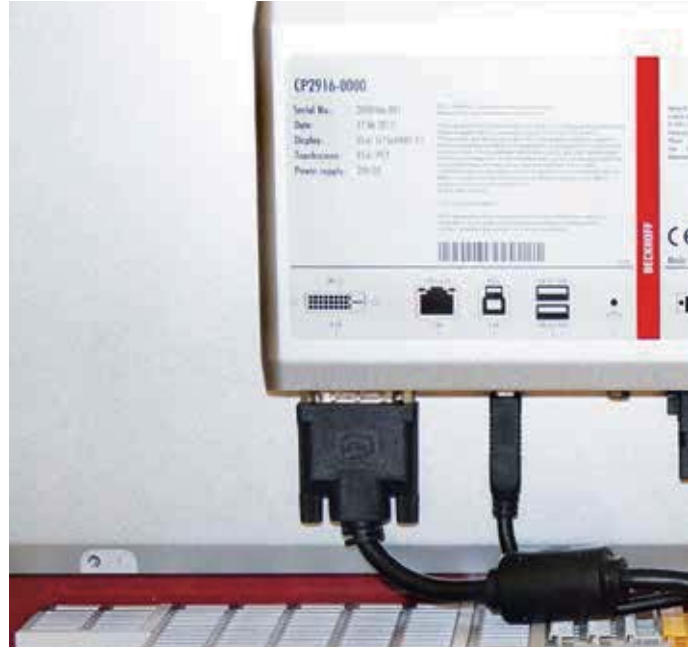
通过紧凑型设计, 控制面板、嵌入式控制器和 EtherCAT I/O 组件可以装到操作站外壳中
