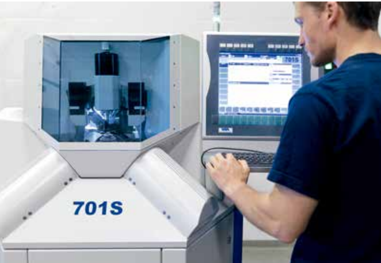
加工中心通过一台定制的带 15 英寸触摸屏的 Beckhoff CP7912 “经济型”控制面板进行操作
