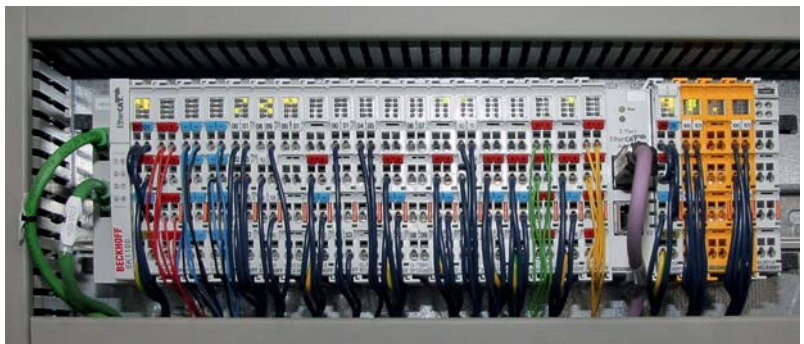
借助 TwinCAT 系统管理器可轻松将 TwinSAFE 端子模块集成到网络中
