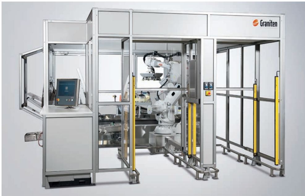
Graniten Engineering 公司以 XTS 系统为核心的下线包装机
