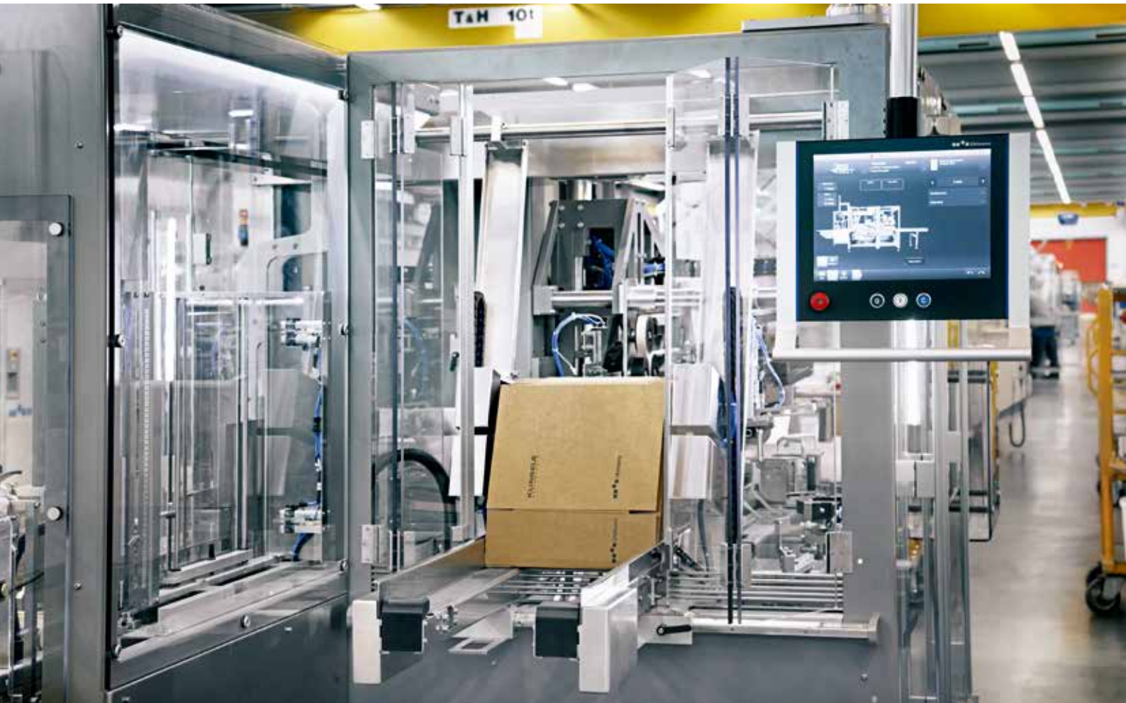
根据公司的企业形象设计的新型操作面板也可以用于乌尔曼的纸盒包装中心 10
