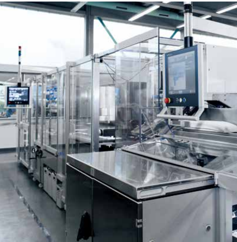
两个新的操作装置用在 10 米长的双通道 BEC500 泡罩高速加工中心中
