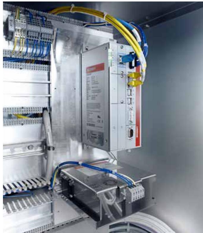
C6930 控制柜式工业 PC—采用 Intel®Core™ i5 处理器，配备 SSD 及由 24 V 电池组构成的集成式 UPS — 通过 CP-Link 4 与操作面板连接
