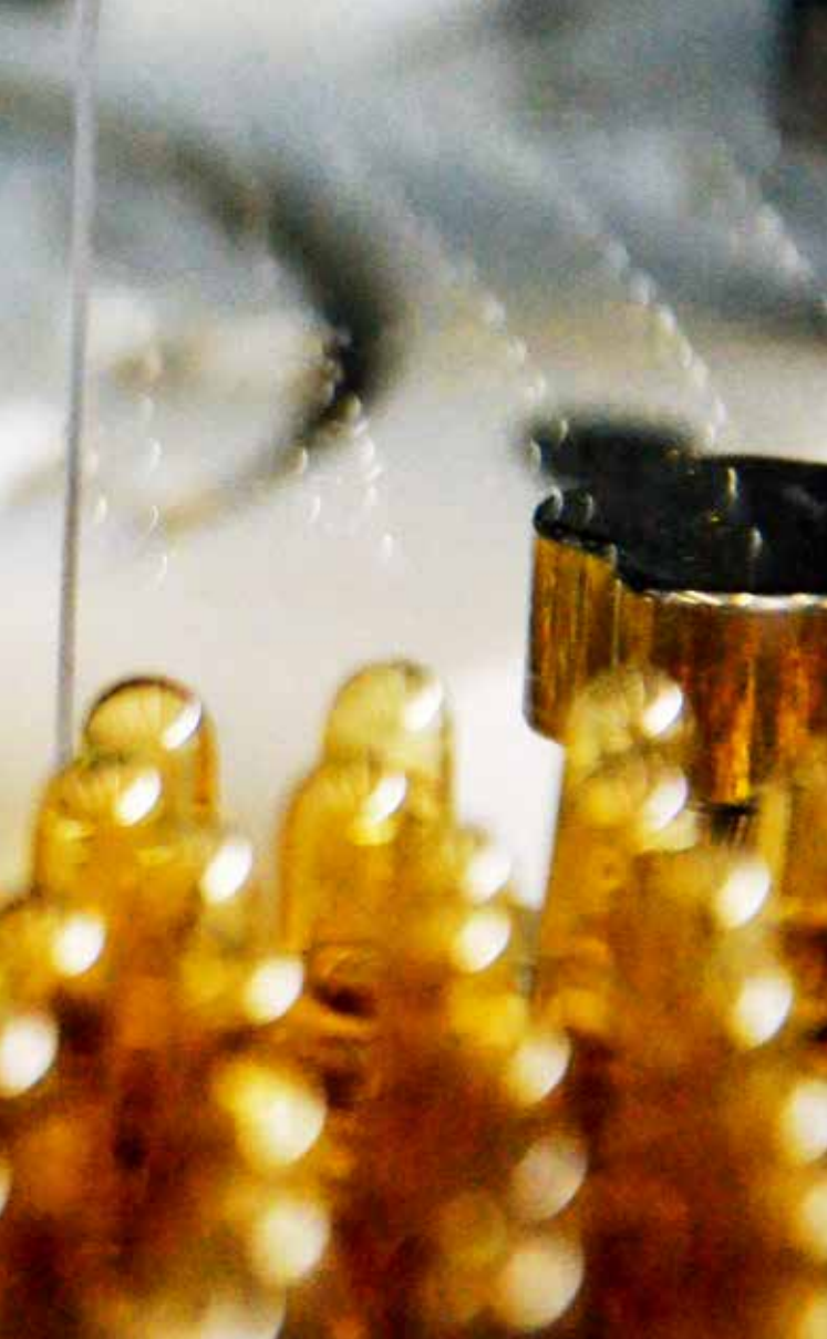
灯检机可靠地检测瓶体本身是否有破损或裂纹（微观缺陷），自动剔除不合格产品
