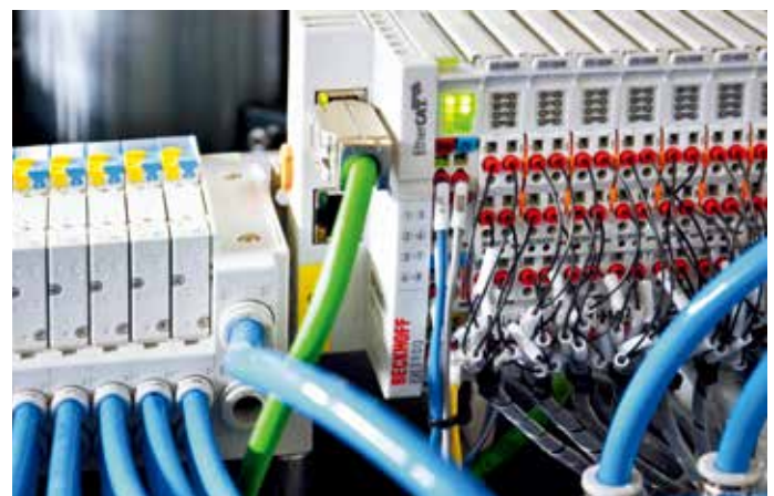
东富龙使用 EtherCAT 作为其灯检机的现场总线系统。数据通过 EtherCAT 端子模块和总线端子模块传输
