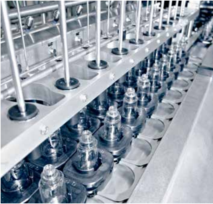
10 瓶为一批次灌装香精，然后与它们的工件托架一起推送到正在等待的 XTS 动子的抓取元件中
