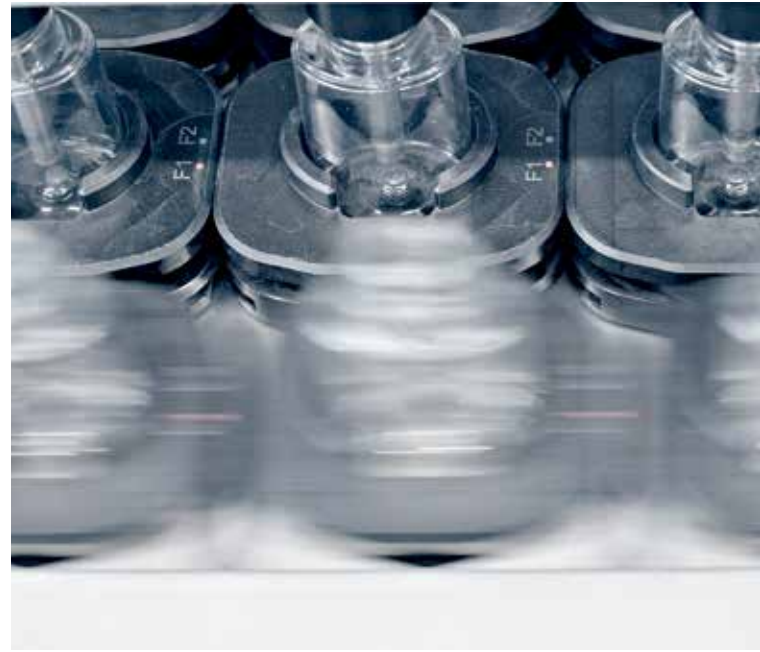
灌装后，10 瓶为一组从静止状态加速，然后与连续的封口过程动态同步
