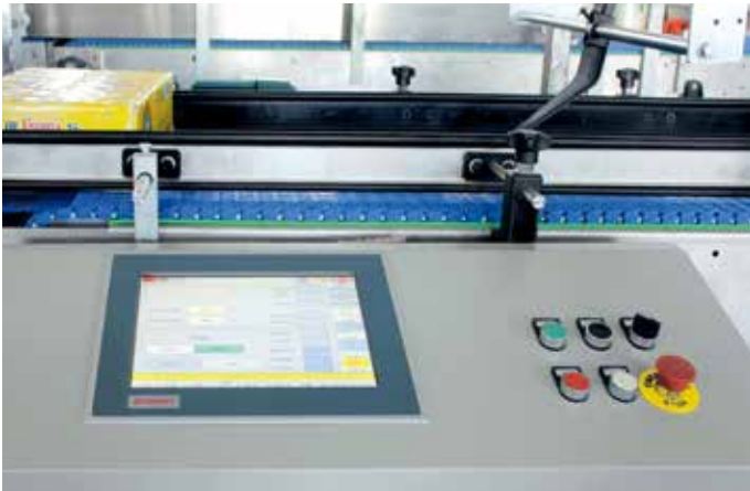
热收缩膜包装机系统通过适合控制柜安装的“经济型”控制面板操控
