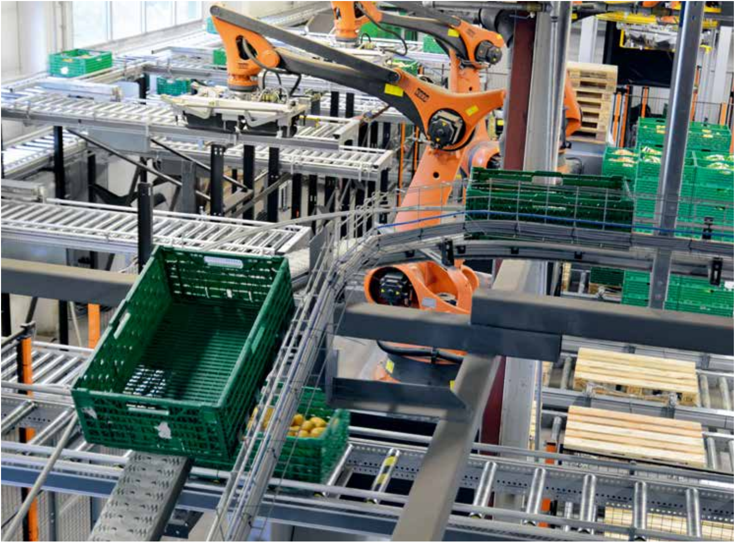
机器人拿起空的托盘并将袋子堆放到上面
