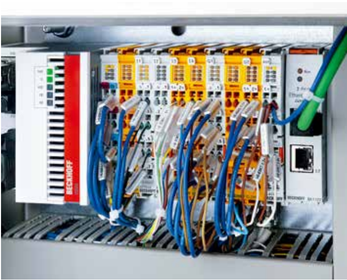
整个灌装系统由 CX5020 嵌入式控制器通过 EtherCAT 端子模块控制
