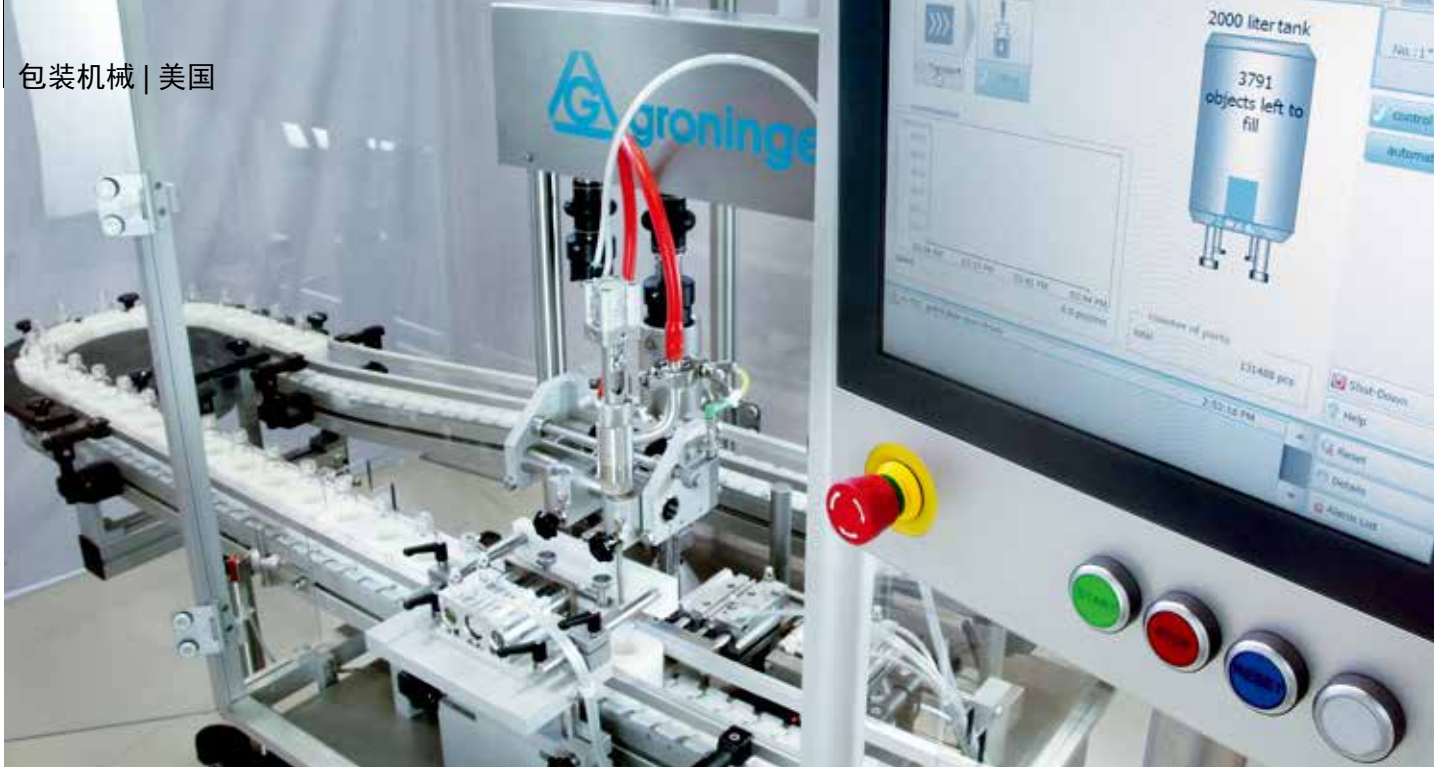
lite-F 的灌装系统为高精度应用使用 Groninger 成熟的正位移泵
