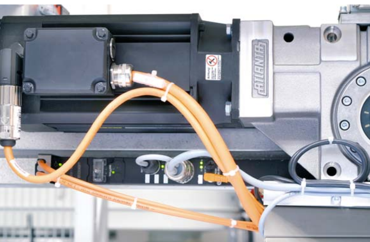
伺服电机，配备了抗干扰的 IP 67 现场总线端子盒
