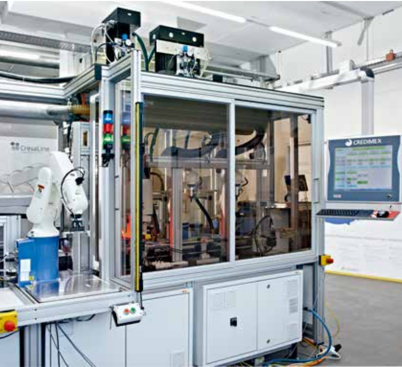
XTS 链接 5 个 CresaLine 型号的加工工位
