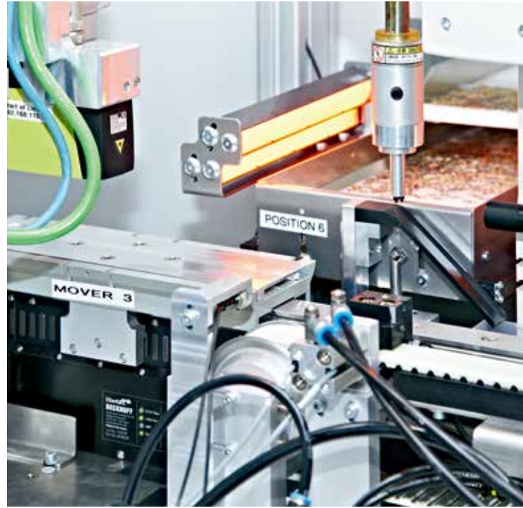
输送系统和加工工位的解耦在小型零件装配中特别重要
