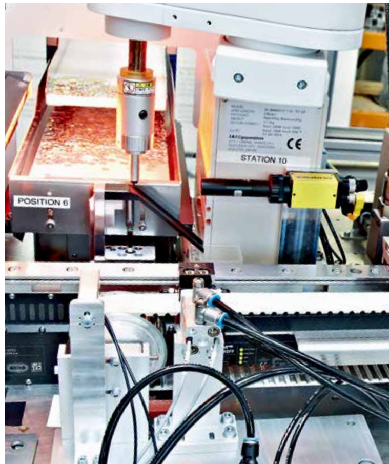
XTS 直线输送系统在工作台下面有一个动子返回段
