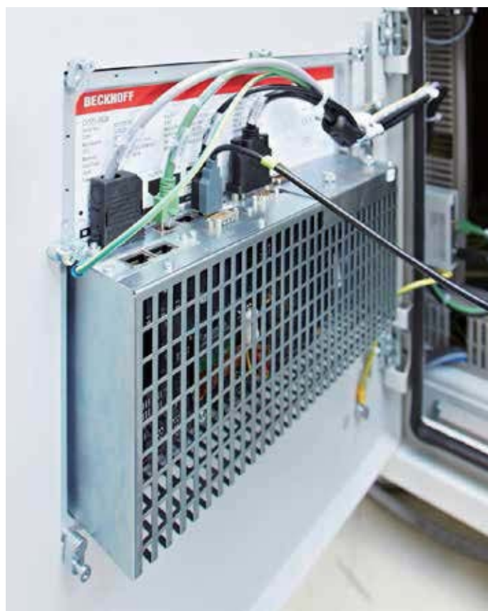
具有外部散热片的无风扇工业 PC C6525（左图）专为节省空间的控制柜安装而设计
