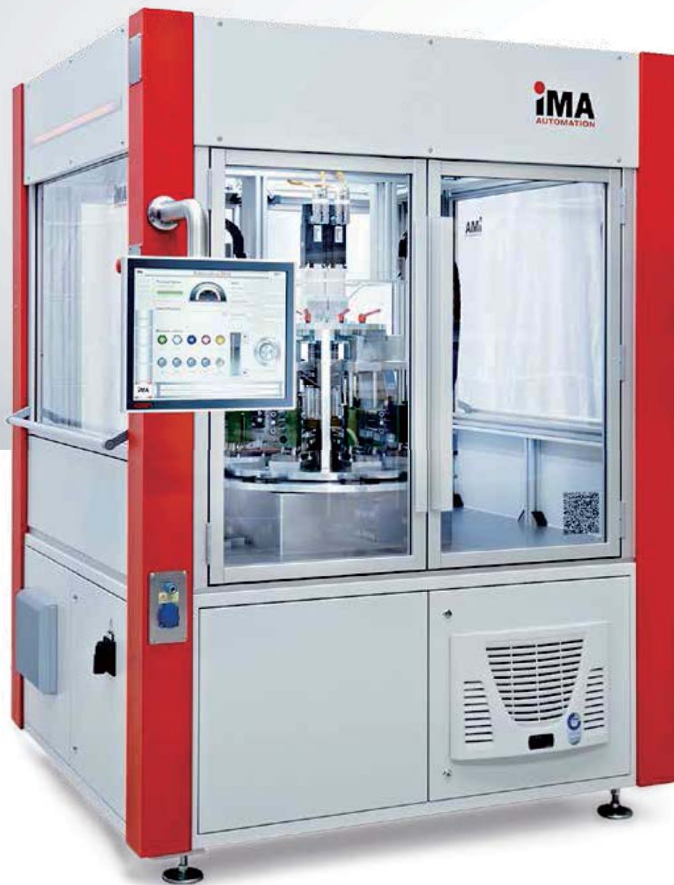
IMA 公司在 Automatica 2014 展会上展出的 CGM 旋转分度台采用基于 PC 的运动控制系统，结构特别紧凑和多样化
