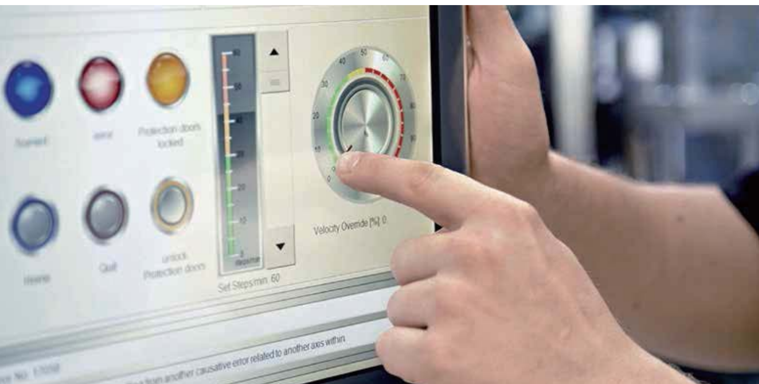
利用 CP3919 控制面板的多点触控功能，可以通过软件灵活地集成一个图形旋转控制器
