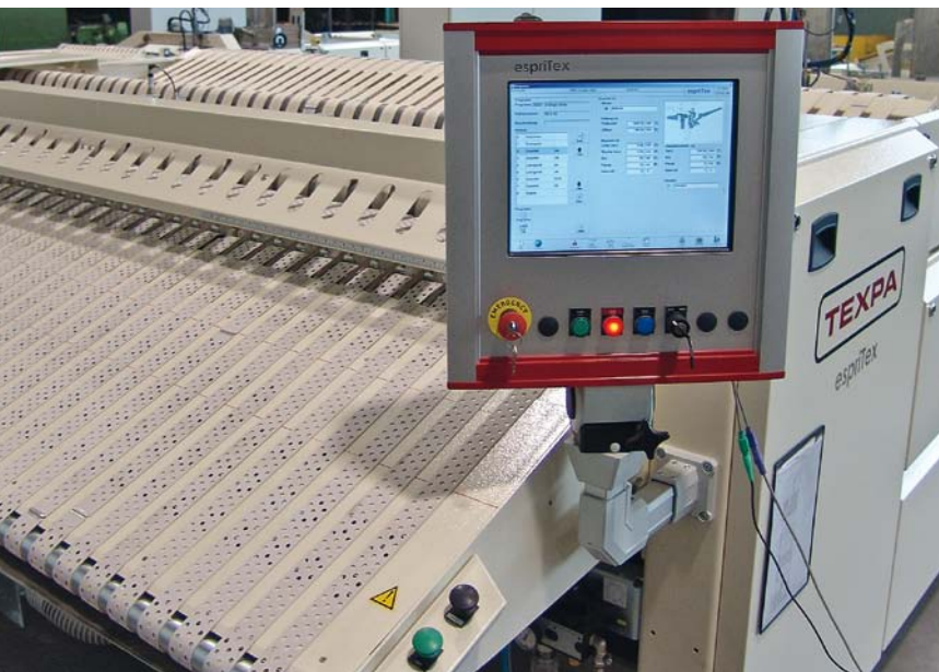
espiTex 模块化折叠机采用倍福的触摸屏控制面板作为客户专用配置的操作单元
