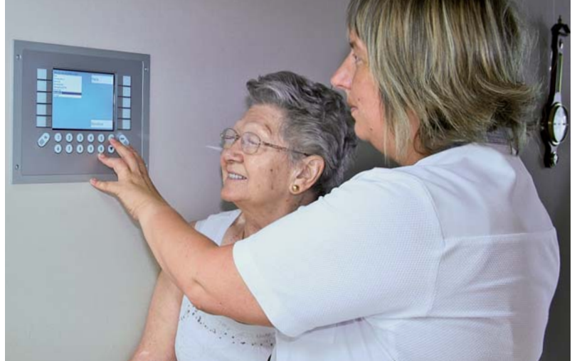
每间房内都安装了一台带有触摸屏的 Beckhoff 面板型 PC。护理人员可以通过一个身份识别按键登入该 PC 来输入或查看数据
