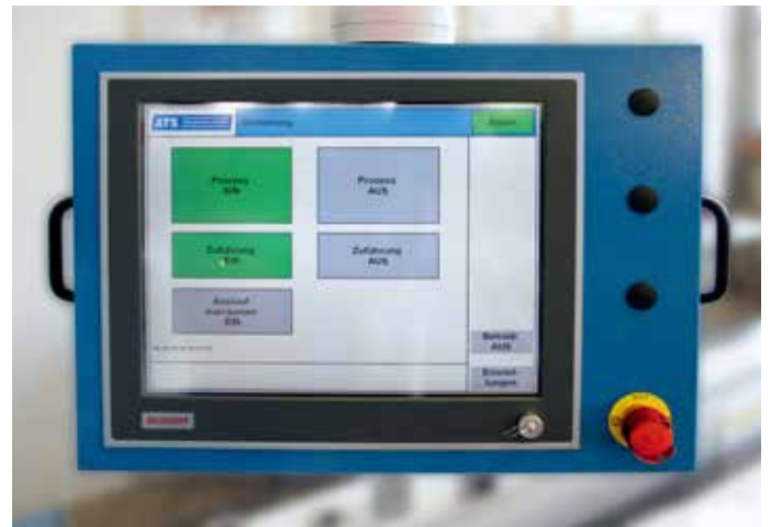
适合控制柜安装的 CP6203 面板型 PC 配备 19 英寸触摸屏，为清晰显示由 TwinCAT HMI 软件创建的可视化界面提供了足够的空间
