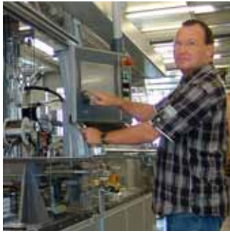
Peter Beerle, Komax AG 软件组组长：我们试图尽可能地在“CPU”上运行软 PLC 和可视化程序。然而，如果我们在一台设备中使用了 30 台伺服驱动器，我们就需要使用配备有 Core Duo 处理器的工业 PC
