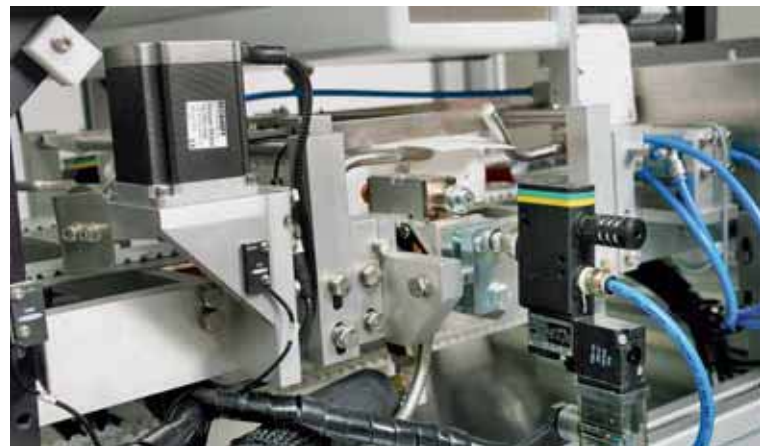
步进电机能够直接接入总线端子模块系统, 无需使用额外的驱动器
