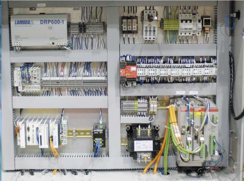
取放设备集成了总线耦合器 BK5120 和 Beckhoff 紧凑型伺服驱动器 AX2500，它们通过 CANopen 与嵌入式 PC CX1000 联网
