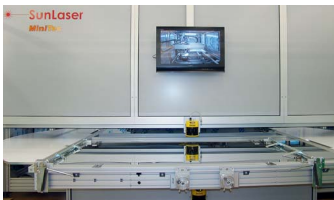
SunLaser® 平板式激光焊接系统可用于生产 1250 mm x 2500 mm (4 ft x 8 ft) 的吸收器
