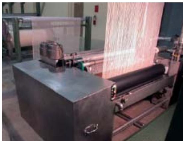
(照片提示): 从不同角度看采用 Beckhoff 控制系统的梳理机
